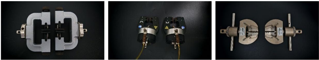
图 6 夹具种类：手动夹具（左）；气动夹具（中）；楔形夹具（右）
